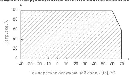
Рис. 3. Максимальная допустимая нагрузка, % от мощности источника
