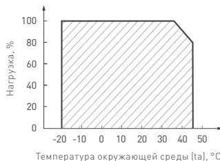
Рис. 3. Максимальная допустимая нагрузка, % от мощности источника
