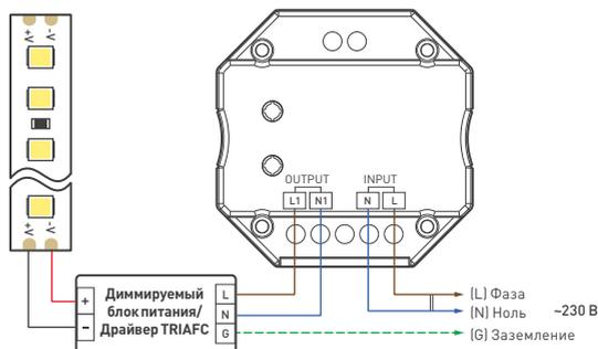
Рис. 1б. Схема подключения диммируемого блока питания/драйвера TRIAFC к панели SMART
