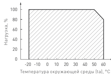
Рис. 2. Максимальная допустимая нагрузка, % от мощности источника
