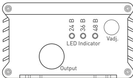
Рис. 1. Расположение индикаторов и регулятора Vadj
