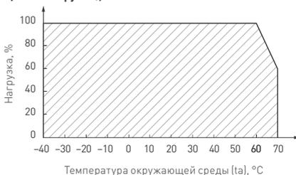
Рис. 3. Максимальная допустимая нагрузка, % от мощности источника
