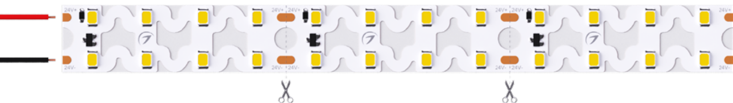
Схема 1: подключение нескольких светодиодных лент с одной стороны
